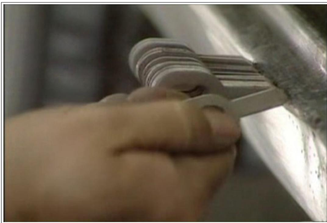
рис.5 - Пример использования ОТ-шайб.
