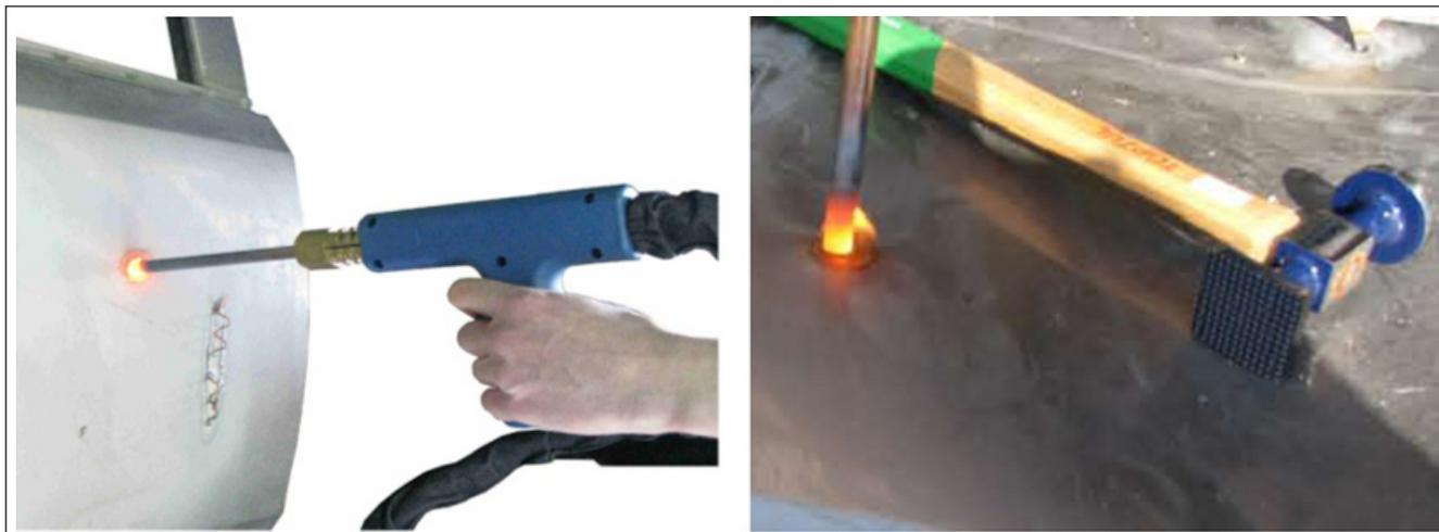
рис.8 - Пример использования углеродного стержня.
