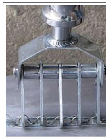
рис.4 - Выравнивание при помощи захвата “гребенка”.
