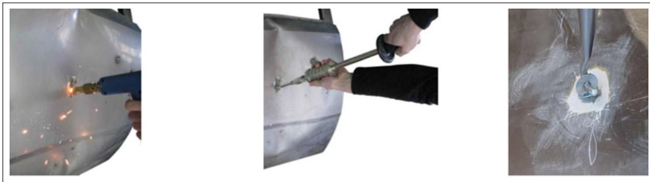
рис.7 - Пример использования насадки “шайба”.
