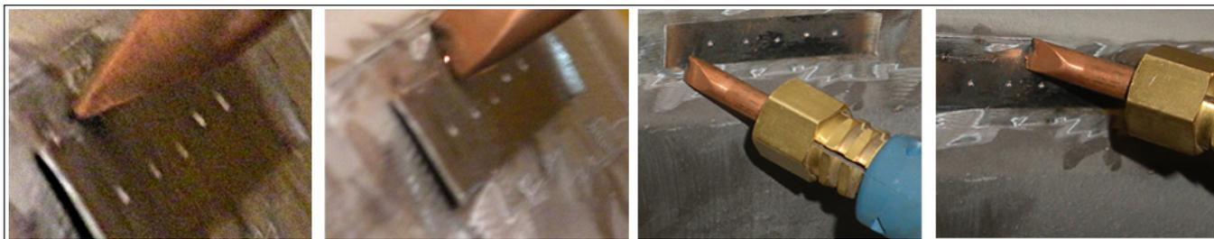
рис.10 - Пример шевной сварки.
