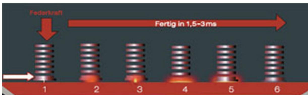
По истечении сварочного времени в 1-3 м/сек и усилия до 15,000А шпилька и основной материал однородно соединены и имеют лишь незначительную сварочную зону в несколько десятых миллиметров. Поэтому шпильки могут привариваться к очень тонким листам без существенных деформаций и обесцвечивания на них с обратной стороны.
