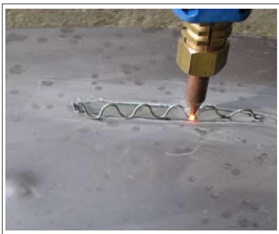
рис.3 - Приваривание волнистой линии.
